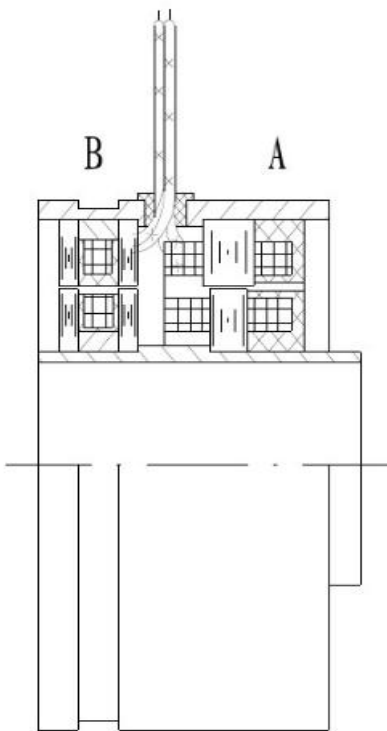
图 1、环形变压器式旋变结构示意图
